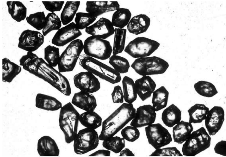
Рис. 1.2. Кристаллы циркона для определения радиометрического возраста; кембрий (530,7±0,9 млн лет); Восточный Ньюфаундленд, Канада (публикуется с разрешения Джозефа Киршвинка)
